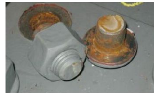
高力ボルト(F11T)の遅れ破壊
