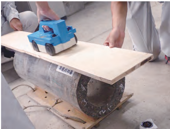
図-4 電柱の測定状況
