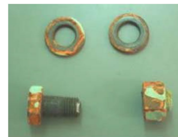
遅れ破壊したボルト
